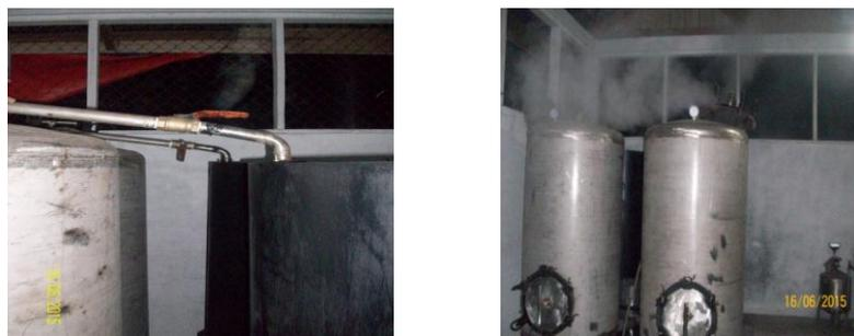
**Gambar 10. Foto kebocoran pada pipa kondensor yang menyebabkan berhentinya sementara proses penyulingan**
