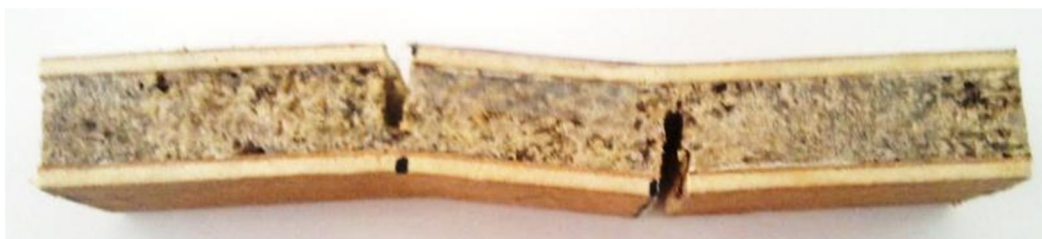
Gambar 4. Bentuk kerusakan pada bagian vinir
