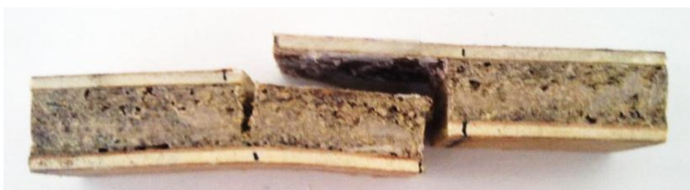
Gambar 5 Bentuk kerusakan pada garis rekat
