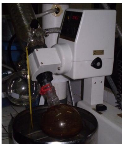
**Gambar 2.** Proses Pemekatan dengan Rotavapor
