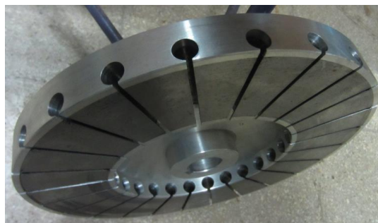
Gambar 5 alur-alur stator dan rotor alur rotor yang telah difabrikasi
