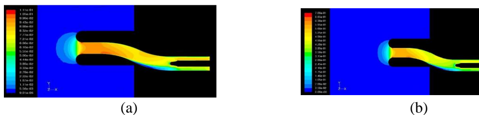
Gambar 2: (a) Kontur bilangan Mach kapasitas aliran pada outlet 1.2135 kg/s dan (b) 4 kg/s
