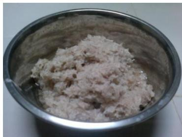
Gambar 2. Serat rami yang telah dimasak dengan NaOH 5%
