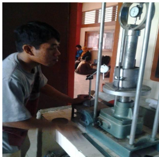
Gambar 4. Foto Pelaksanaan Pengujian CBR di Laboratorium
