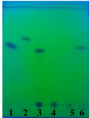
Gambar 3 Kromatogram lapis tipis hasil pemisahan dengan OASIS HLB, (1) standar kerja parasetamol (2) standar kerjadeksametason, (3) filtrat jamu simulasi, (4) load, (5) larutan pencuci, (6) hasil elusi, dilihat di bawah sinar UV \lambda 254 nm.
